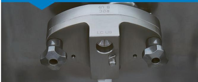
**Gravitation - G Version.** Die unterschiedlichen Durchmesser der Löcher auf der Zufuhrnadel dosieren die Mischung auf natürliche Weise mit Luft; für ein trockenes und kompaktes Eis und einen Aufschlag bis zu 40%. Der Schieber für die Nadeleinstellung ermöglicht, dank der wiederholten Bohrungen sowohl im unteren als auch im oberen Teil der Nadel, die Aufschlageinstellung auch bei vollem Tank.
